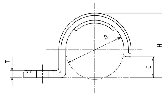
注1. サンフレキROBO / NTを造管材に固定するための、片側止めサドルです。
