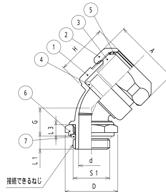
注1. 防水プリカをリミットスイッチ等のめねじに接続するための、45形の亜鉛合金ダイカスト製管用平行ねじ付きコネクタです。
