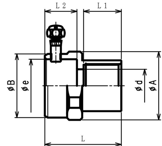
注1. プリカチューブをねじなし/薄鋼電線管に接続するための、ストレート形の亜鉛合金ダイカスト製小ねじ止め式コンビネーションカップリングです。
