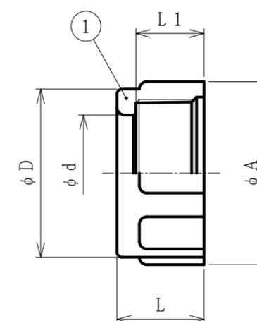
注1. 電線の被覆を損傷させないように、プリカチューブの端末に取り付けるポリカポネート製の絶縁型ブッシングです。
