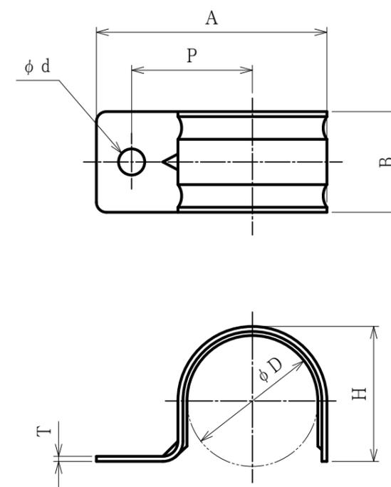
注1. ケイフレックスを造営材に固定するための、鋼製片側止めサドルです。
